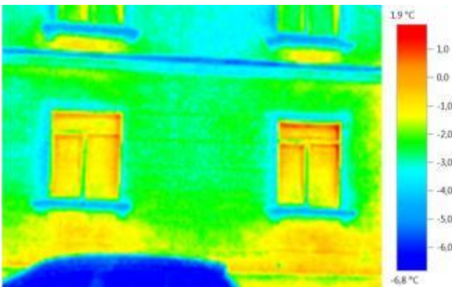
Рис.П95. Потери через стены от приборов отопления
